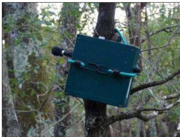
Station fixe d'enregistrement automatique des signaux de chiroptères avec système SM2BAT. Le dispositif est fixé sur un arbre.
